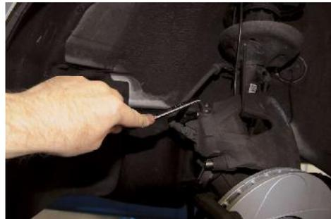
La llave especial de purga de aire ATE es una llave anular hexagonal con un codo largo y un codo corto. El ancho de llave es de 7 mm para vehículos Volkswagen. Permite el uso sin necesidad de desmontar las ruedas.
