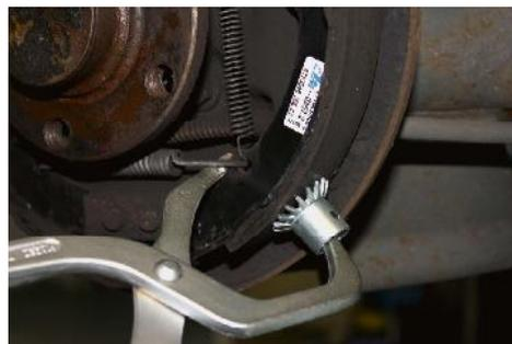
Con las tenazas para resortes de freno ATE (medianas) se pueden desmontar y montar de forma fácil y segura los resortes de retirada de las zapatas de freno en frenos de tambor. El platillo de apoyo articulado se apoya con sus afiladas garras sobre la superficie de los forros de freno. El gancho permite colgar el resorte de forma segura.
