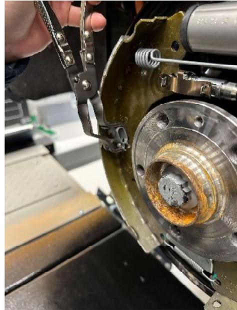
Las tenazas de montaje de resortes ATE se usa para montar y desmontar de forma segura y sin problemas los resortes de sujeción de las zapatas de los frenos de tambor en sistemas ATE, p. ej. en el Mercedes Benz Clase A, VW ID 3/4/5. Es casi imposible manipular el resorte de sujeción sin las tenazas de montaje de resortes ATE.
