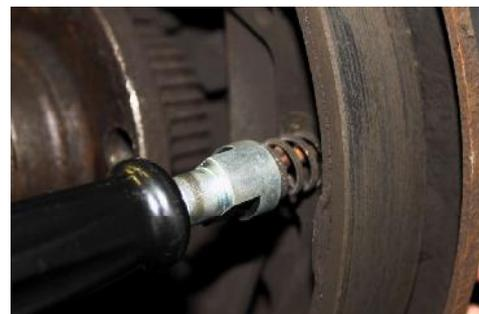
La herramienta de montaje de resortes ATE se usa para desmontar y montar de forma segura y sin problemas los platillos de los resortes de sujeción de las zapatas de freno. Gracias a la boca de entrada de dos tamaños distintos se pueden coger platillos de sujeción grandes y pequeños de los resortes de sujeción de las zapatas de freno.
