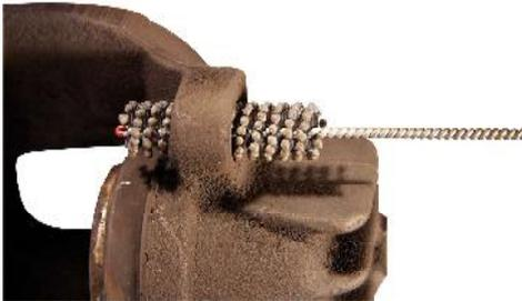
Después de un determinado recorrido de kilómetros puede resultar razonable cambiar los manguitos de guía (de goma) en las pinzas de freno ATE. El taladro de alojamiento de la carcasa de la pinza frecuentemente se encuentra oxidado en mayor o menor medida. De esta forma se presiona el manguito de guía y los pernos de guía quedan fijados. La pinza del freno ya no se puede mover libremente y surgirán más problemas de frenos.
