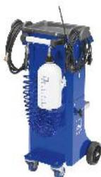
El cambio del líquido de frenos en los automóviles modernos con sistemas automáticos de frenado requiere el uso de modernos dispositivos de servicio. Con la tecnología innovadora de "la regulación electrónica de la presión" (EDR) con niveles de presión variables y preindicados, así como un dispositivo de succión integrado, el nuevo ATE FB 30 SR es una referencia entre los equipos de llenado y purgado.
