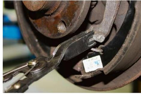
Con las tenazas de resorte para el cable del freno de estacionamiento ATE se puede colgar segura y cómodamente el cable del freno de estacionamiento en la palanca de las zapatas en frenos de tambor. Resulta especialmente útil para montar el ATE Top Kit.
