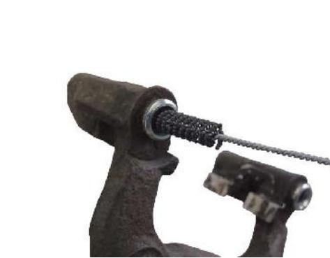
Para guiar las pinzas "LUCAS" se utilizan pernos de guía lubricados. Estos se obturan con fuelles. Si los fuelles están dañados, los casquillos guía se corroen en el soporte de la pinza portapastillas. Como consecuencia, la guía de pinza flotante está dura y se producen otros problemas de frenado.
