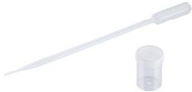
Con las pipetas de un solo uso podrá retirar líquido de frenos del vehículo y llenar los vasos de ensayo de un solo uso para determinar el punto de ebullición con el equipo ATE BFT 320.
