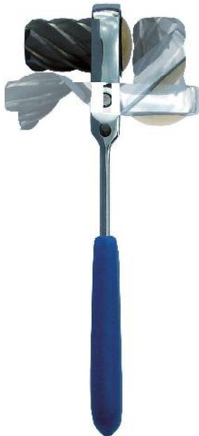
Antes del montaje de un sensor de revoluciones de rueda ABS nuevo, debe limpiarse a fondo y dimensionarse nominalmente el taladro de alojamiento respectivo. El escariador de ATE es una herramienta ideal para ello.
