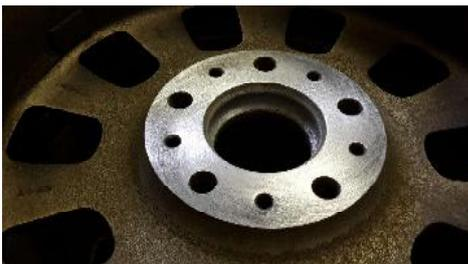
El juego de limpieza para pestañas de llanta de ATE es una herramienta ideal para la limpieza rápida, segura y económica de la superficie de las llantas. Se recomienda limpiar la superficie de la llanta hacia el disco de freno antes del montaje de la llanta. Solo así podrán lograrse tolerancias mínimas entre la llanta y el disco de freno.
