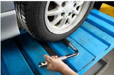
El comprobador de la suspensión es un instrumento sencillo y muy efectivo para localizar el juego del cojinete en el área de los ejes. Con la suspensión bajo carga, mediante el comprobador de la suspensión se puede localizar rápida y fácilmente el juego del cojinete en el cojinete de la pata telescópica / suspensión articulada / rótula de dirección / cojinete de rueda / rótula axial / mecanismo de dirección, etc.
