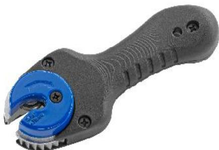
El cortatubos de carraca de ATE es una herramienta ideal para cortar profesionalmente tubos de freno con un diámetro de 4,75 mm. Gracias a su construcción compacta y a la función de carraca también es posible utilizarlo directamente en el vehículo, incluso en espacios reducidos. La función de reajuste automático suprime el pretensado de la rueda de corte durante el proceso de corte. Gracias al efecto de palanca adicional por la longitud del mango es necesario poco esfuerzo.
