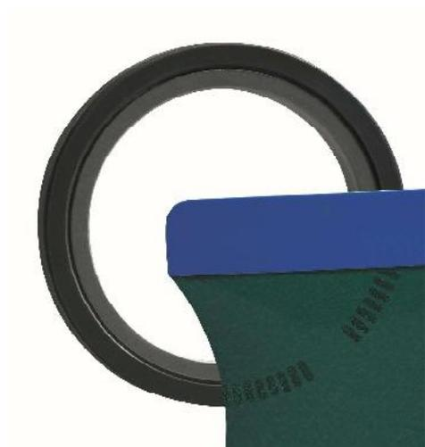
Los nuevos sensores de revolución activos trabajan a través de anillos de sensor magnéticos. Estos vienen integrados en la protección de goma del perímetro del rodamiento. La goma se enriquece con polvo de hierro y se añaden los campos magnéticos. Los campos magnéticos son muy delicados.
