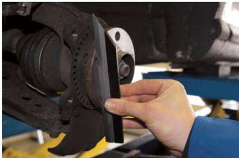
Antes de montar los discos de freno se debe comprobar la lisura (deformación) de los bujes de rueda. Dicha comprobación resulta particularmente sencilla con la regla de canto agudo, cuyo método se basa en la presencia de rendijas de luz. Con una longitud de 200 mm se pueden verificar también superficies más grandes sin problemas.
