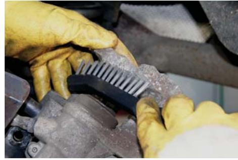
El cepillo de alambre especial ATE se usa para eliminar las pequeñas impurezas depositadas en las superficies guía de las pinzas y soportes de freno.
