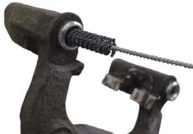
Para guiar las pinzas "LUCAS" se utilizan pernos de guía lubricados. Estos se obturan con fuelles. Si los fuelles están dañados, los casquillos guía se corroen en el soporte de la pinza portapastillas. Como consecuencia, la guía de pinza flotante está dura y se producen otros problemas de frenado.
