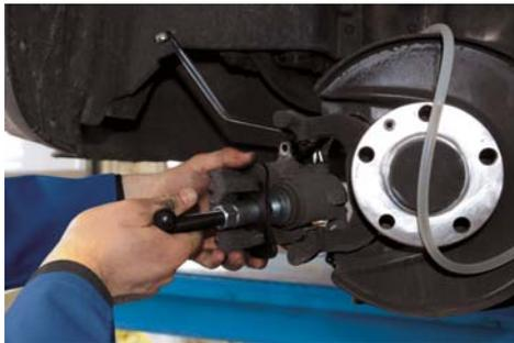
En pinzas tipo puño con freno de mano integrado (pinzas combinadas), no se debe hacer retroceder el pistón simplemente presionando hacia atrás, de lo contrario se puede romper el mecanismo de reajuste de la pinza. El pistón se debe girar y empujar al mismo tiempo. Y esto se consigue con el juego de herramientas para reposición de pistones ATE. Con sus 9 adaptadores intercambiables resulta idóneo para todos los vehículos corrientes. Se pueden reposicionar también las pinzas tipo puño normales.
