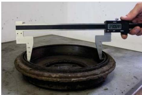
El calibre digital para tambores de freno ATE es un instrumento indispensable para poder calcular con precisión el estado de desgaste de los tambores de freno. Permite la medición rápida y sencilla del grosor del tambor de freno o del nivel de desgaste. El rango de medición es de 400 mm. El diseño de las bocas de medición permite la medición exacta a pesar de la rebaba en el tambor de freno.
