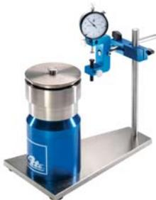
Con el dispositivo de medición de los discos de freno ATE se puede verificar con precisión la planeidad de los discos de freno sin montar ( sin el asiento de cojinete ). Es posible de verificar discos de freno hasta un diámetro de 360mm.
