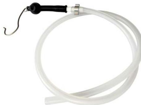
La manguera de purgado de 90° de ATE es un accesorio útil para el purgado en espacios reducidos. Dada su construcción compacta, el adaptador sólo ocupa 19 mm, permitiendo así la recogida del líquido de frenos en zonas de difícil acceso.
